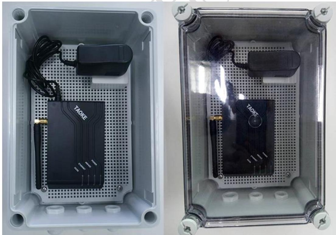
注意二：采集器与采集器相配套的防水盒不允许装在朝阳面，需安装在阴凉通风处(如下图)。采集器或防水盒暴晒引起的采集器损坏，TAOKE 不提供质保；
